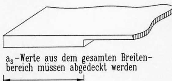
Bild 6: Breiter Unterzug einer Deckenplatte
